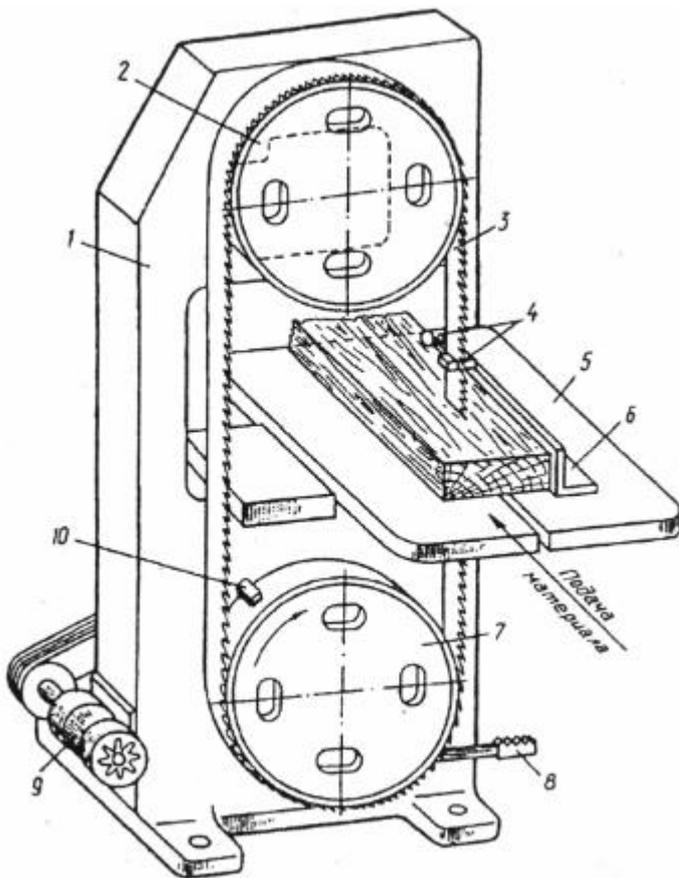
1 — станина; 2 — верхний не приводной шкив; 3 — ленточная пила; 4 — ограждение пилы с направляющим устройством; 5 — стол; 6 — направляющая линейка; 7 — нижний шкив; 8 — педаль тормозного устройства; 9 — электродвигатель; 10 — щетка
